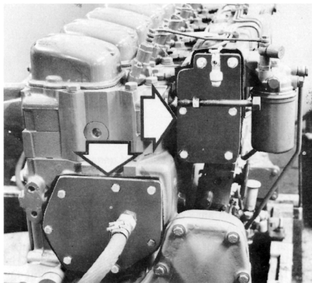
Fig. 51. Provtryckning av cylinderblock
