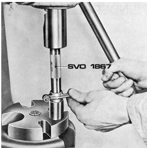
Bild B6. Byte av bussning i vipparm
