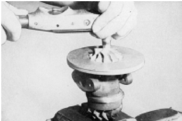
B. Ta bort kompressorhjulet. Om hjulet sitter fast: pressa ut axeln.
