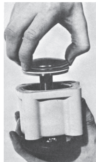
Fig. 49. Montering av kolv i trimcylindern
