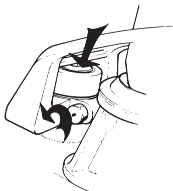
Fig. 22. Demontering av styrarm
