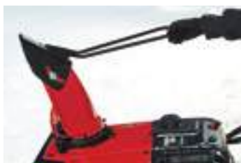
Manuell kontroll av utkastet på HS 750 EMA
